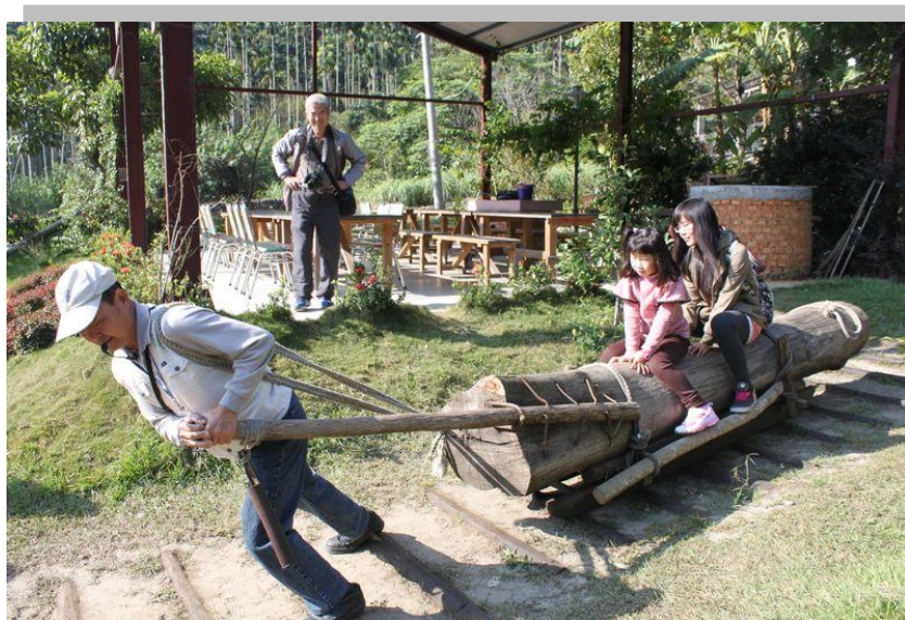
圖 2、木馬道：在地上埋設圓木，以便於用人工搬運大型木材。
